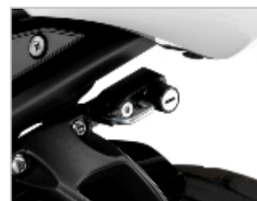
開閉キーはメインキーと共通の ヘルメットロックステー (ワイズギア製)
